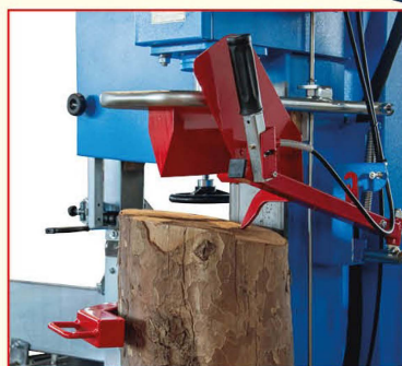
Spaccalegna oleodinamico con comando a due mani
